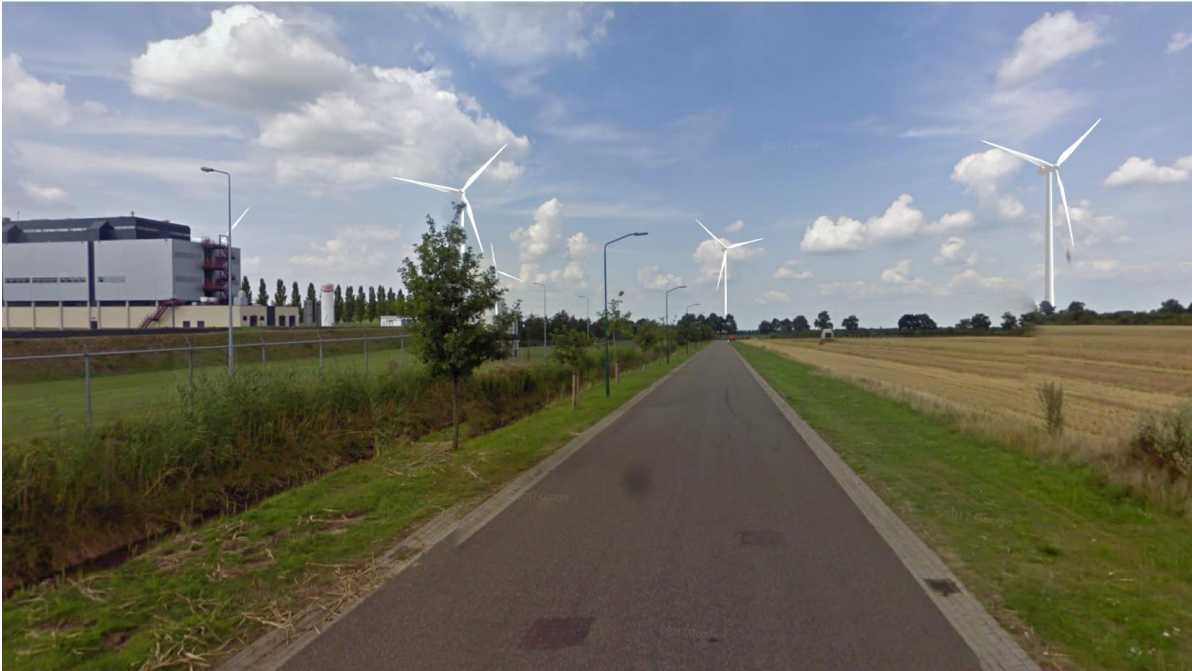
Figuur 4.9 Visualisatie vanaf zuidzijde (Vollenhovermeer, oostrand bedrijventerrein De Geer) in noordelijke richting van 2 verschillende windturbinetypes met gelijke typologie maar afwijkende maten (links in beeld 2x Vestas V126 op ashoogte 137 meter (de meest linker windturbine is vervallen in dit bestemmingsplan) en rechts 3x Vestas V136 op 142 meter ashoogte). De verschillende rotordiameter valt op deze afstand niet op. (bron: Windplanner)
