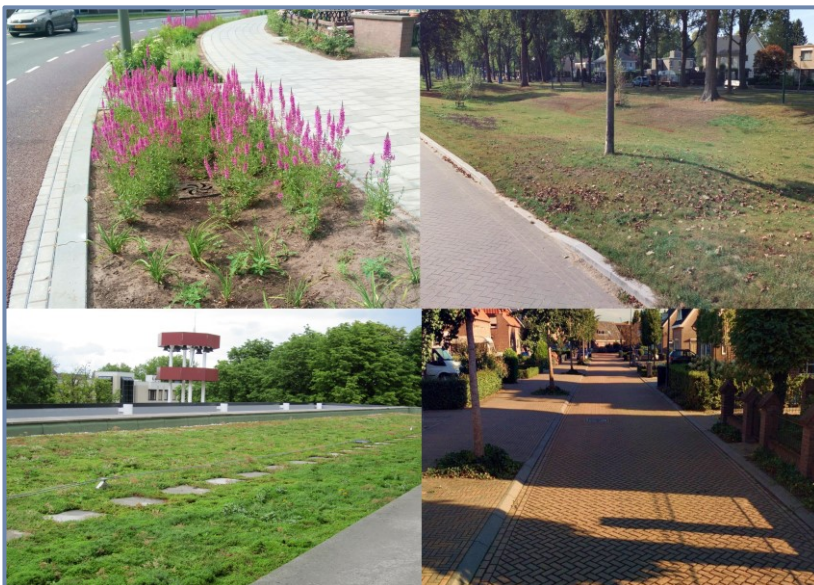
Figuur 3-3 Voorbeelden klimaatadaptieve inrichting, linksboven: Bioswale Oostwal. rechtsboven: Wadi Nieuwe Hescheweg. linksonder: groen dak gemeentehuis. rechtsonder: waterpasserende verharding Heegterstraat.
