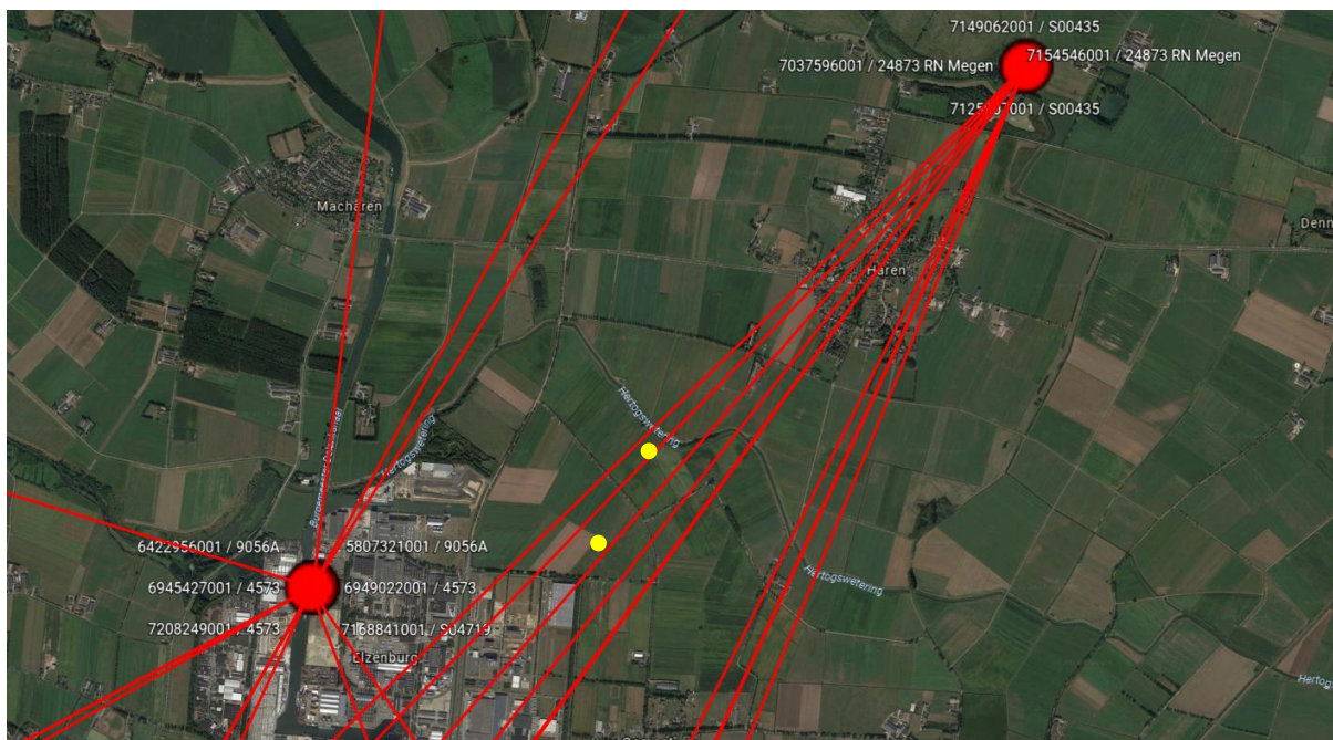
Afbeelding 1: straalpaden (rood) en turbines 'in aandachtszone' (geel).
