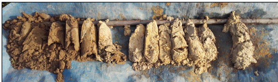
Figuur 3.17 Zicht op boring 159 (d.d. 21-08-2018), welke kenmerkend is voor de bodem ter plekke van het oostelijke deel van deelgebied 2. De boring loopt van links naar rechts. De bovenste 25 cm bestaat uit een bruine bouwvoor, waaronder een 15 cm dik oeverpakket bestaande uit sterk zandige klei is aangetroffen. Het oeverdekje bestaat uit een dunne, donkergrijze Ahb-horizont op een lichtgrijze C-horizont, die stug aanvoelt. Vanaf circa 40 cm –mv (5,0 m +NAP) wordt grijs, matig tot zeer grof, grindrijk zand aangetroffen met gley-verschijnselen.
