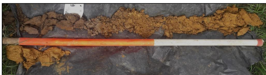
Figuur 3.16 Zicht op boring 139 welke kenmerkend is voor de bodemopbouw in het westelijke deel van het deelgebied 2. De boring loopt van linksboven naar rechtsonder (d.d. 20-08-2018). In het verweerde oeverdek heeft zich een slecht ontwikkelde moderpodzol kunnen ontwikkelen met vanaf 30 cm –mv een donkergrijze Ah, een beigegrijze EB-horizont en vanaf 45 cm –mv een bruingele BC-horizont. Het originele oeversediment op het Pleniglaciaal rivierterras bestaat hier uit matgeel tot (licht)bruingeel, silthoudend, matig grof zand. Vanaf 100 cm –mv komen oranjegele beddingafzettingen voor.
