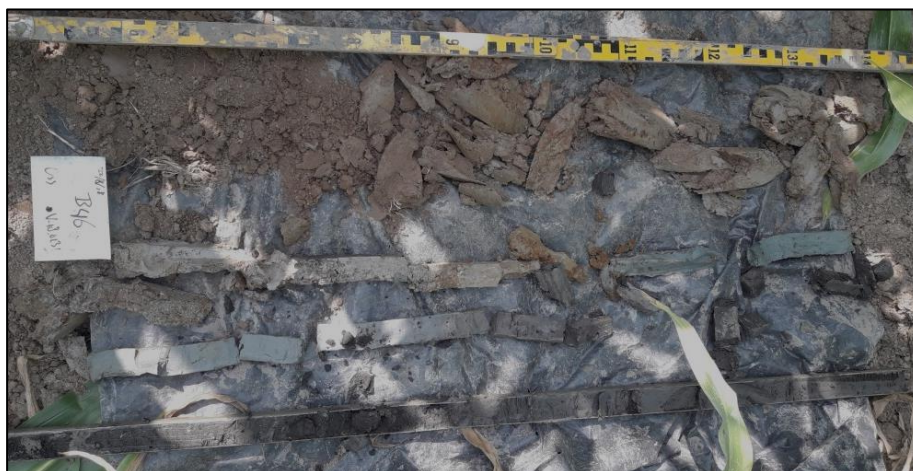
Figuur 3.26 Foto van boring 46 die de bodemopbouw en vulling van een gereactiveerde (kronkelwaard)geul aanduidt (d.d. 22-08-2018). De boring loopt van linksboven naar rechtsonder. De vanaf 1,05 m –mv voorkomende grijze tot blauwgrijze siltrijke klei is afgezet binnen een oorspronkelijk met veen en humeuze klei opgevulde (kronkelwaard)geul.
