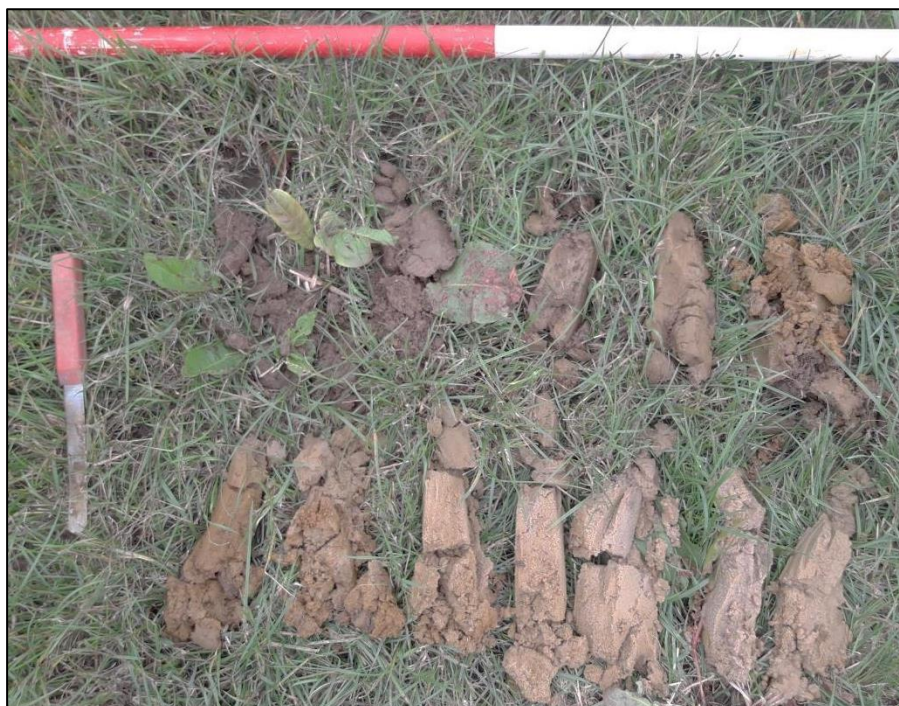
Figuur 3.13 Zicht op boring 41 (d.d. 20-08-2018), welke kenmerkend is voor de bodemopbouw ter plekke van deelgebied 1. De boring loopt van linksboven naar rechtsonder. Onder een 10 cm dikke bouwvoor (Ap) komt een 30 cm dikke grijsbruin kleidek (AC-horizont) voor met in de top enkele houtschoolspikkels. Vanaf 40 cm –mv gaat dit pakket over in sterk zandige leem, waarin veel gley (mangaan- en ijzervlekken) worden aangetroffen (Cg-horizont). Vanaf 55 cm –mv wordt matig tot zeer grof, zwak grindig beddingzand aangetroffen.
