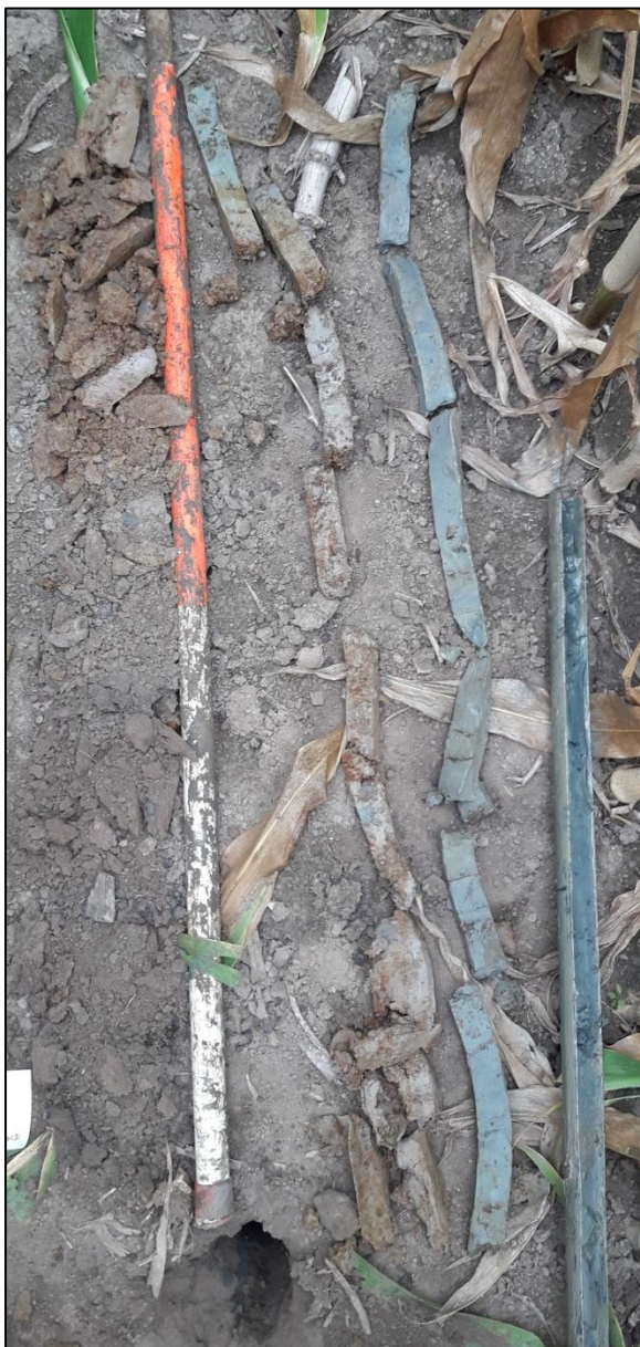
Figuur 3.25 Zicht op boring 69 ter hoogte van AMK-terrein 244 (d.d. 23-08-2018). De boring loopt vanuit links onder naar rechtsboven. Onder de donkergrijze bouwvoor komt een 30 cm dikke licht gebleekte fijnzandige laag voor, die óf opgebracht óf afgezet is tijdens een oeverwaldoorbraak (crevasse) van de Harenstroomgordel.
