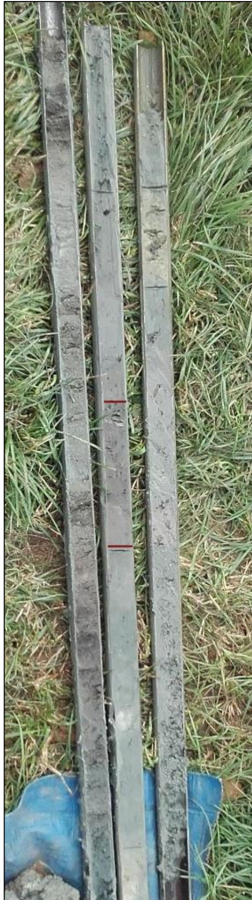
Figuur 3.22 Zicht op de geulvulling in de noordoostelijke tak van de Allerød restgeul ter hoogte van boring 130 (d.d. 21-08-2018). Het betreft 3 meter gutsvullingen die gezien dienen te worden van rechtsonder naar linksboven. Tot 2,5 m -mv komt blauwgrijze slappe klei voor, waaronder een licht(groen)grijze kleilaag met kalkrijke (gyttja)bandjes voorkomt. Op circa 3,5 m -mv komt een donkergrijze laklaag voor in de top van klei met humuslaagjes (tussen de rode lijntjes aangegeven). Deze humeuze klei gaat geleidelijk over in siltrijk, fijn zand met detrituslaagjes. De basis van de geul wordt gevormd door zand met verslagen veenresten.
