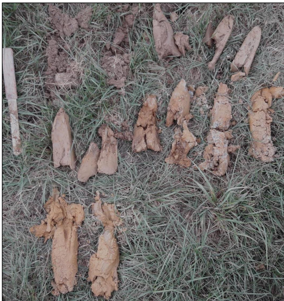
Figuur 3.20 Zicht op boring 119 (d.d. 21-08-2018). De boring loopt van linksboven naar rechtsonder. Er is hier sprake van een Pleniglaciaal rivierterras bestaande uit grijsbruin zand dat vanaf 110 cm –mv wordt afgedekt door een stug pakket vroeg-holocene oeverafzettingen (lichtgrijs met oranje vlekken). De bovenste 75 cm bestaat uit (licht)bruingrijze overstromings- of komklei.
